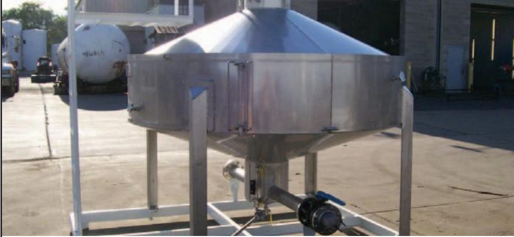
Средства контроля резервуара различных размеров для объемных расходомеров 4”
